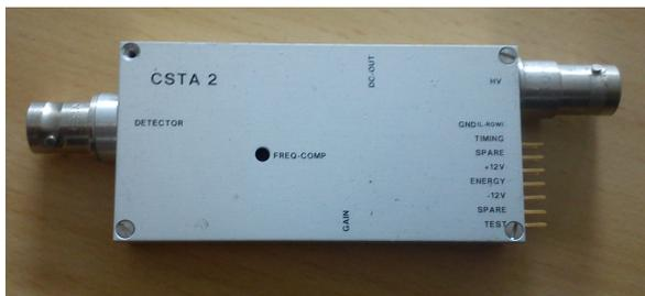
**Abbildung 7.:** CSTA2 Vorverstärker. Die linke Seite wird direkt auf den Deckel der Streukammer gesteckt. Rechts befinden sich HV-BNC Anschluss für die HV-Versorgung und Pins für Signale und die Spannungsversorgung des VVs.
