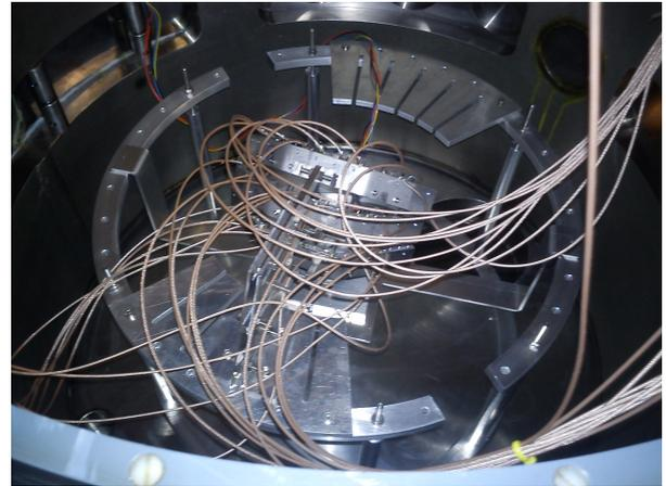
**Abbildung 8.:** Teil des Si-Balls befestigt an der im Rahmen dieser Bachelor Thesis entwickelten Halterung in der Streukammer am QCLAM-Spektrometer.
