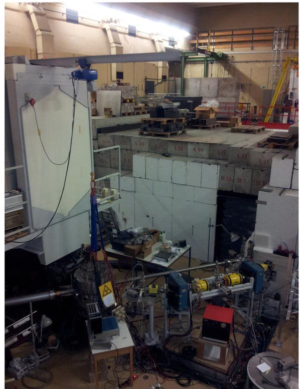
**Abbildung 1.:** QCLAM Aufbau in der Messhalle am IKP. Der Elektronenstrahl kommt durch das Rohr von rechts in die Streukammer und wird dort am Target ins QCLAM-Spektrometer (weißer Kasten links) gestreut.
