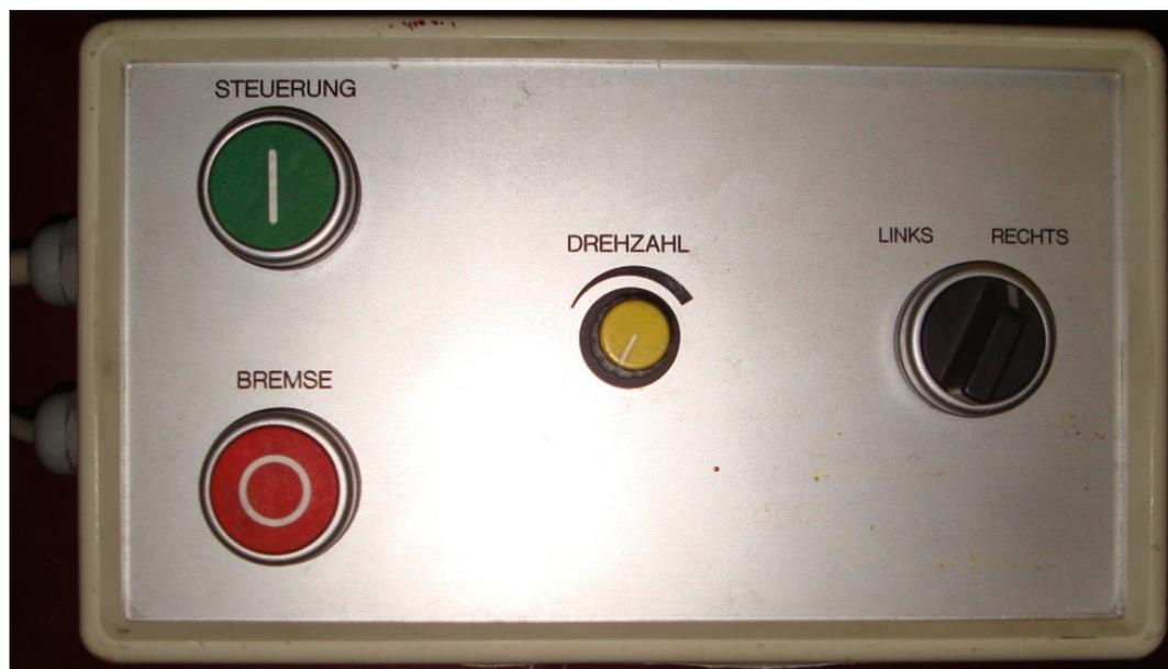
Abbildung 8: Zu sehen ist die alte Steuerung. Sie verfügt über zwei Knöpfe zum Fahren und Anhalten. Die Geschwindigkeit kann mit einem Drehregler eingestellt werden. Ein Zwei-Positionsschalter dient zum Auswählen der Fahrtrichtung.
