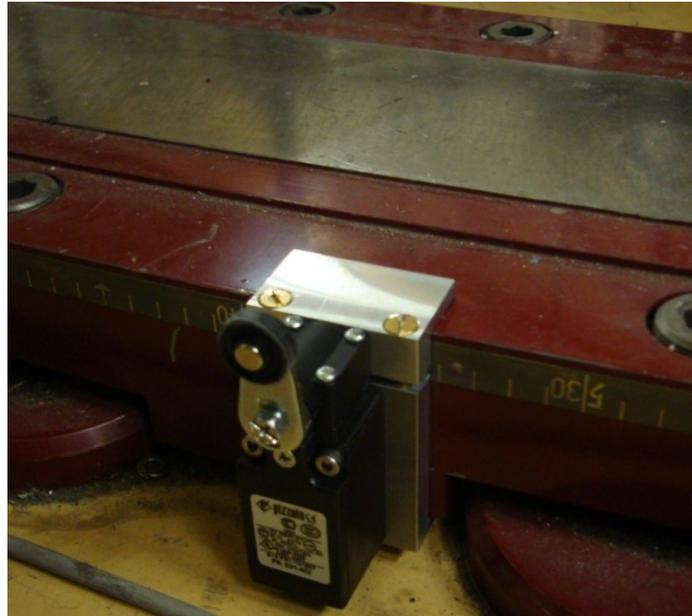
Abbildung 11: Die Endschalter werden mit Klemmen, die in der institutseigenen Mechanik Werkstatt konstruiert wurden, an der Laufschiene befestigt.
