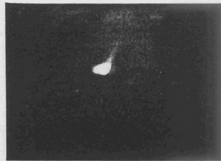
Abb. C3: in x- und y-Richtung fokussierter Elektronenstrahl
