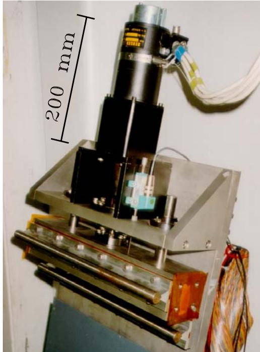
**Abb. 3.1:** Aufnahme des 5-Phasen-Schrittmotors. Außerdem erkennbar ist die bewegliche obere Trägerplatte der Driftkammern, die zu diesem Zeitpunkt ausgebaut sind.
