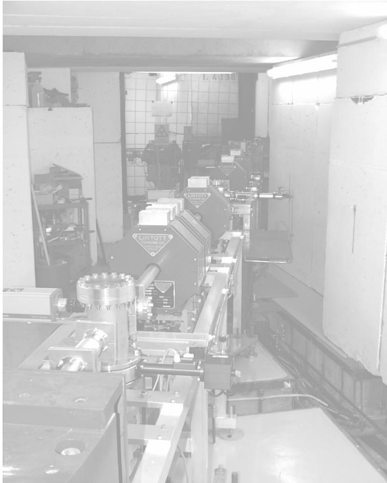
Abb. 4.6: Blick entlang der neuen Strahlführung, Blickrichtung vom zweiten 70°-Dipolmagneten in Richtung des ersten. Zu sehen sind die neue Tischkonstruktion, die Quadrupolmagnete sowie einige Vakuumkomponenten.
