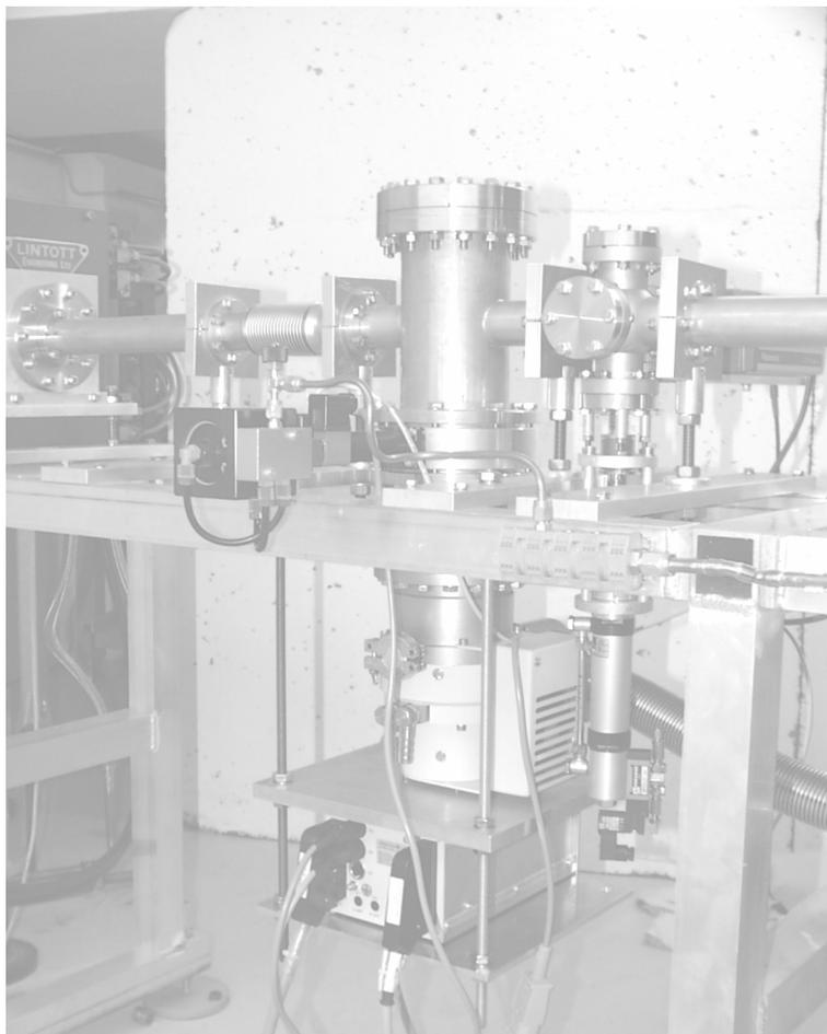
Abb. 5.3: Turbomolekularpumpe E4TP02 mit Anbindung an Strahlrohr und Pneumatikklappe.
