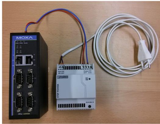
**Abbildung 3.2:** Der Umsetzer wird von einer 24 Volt Gleichspannungsquelle versorgt. Die vier seriellen Anschlüsse bieten Platz für zukünftige Geräte.
