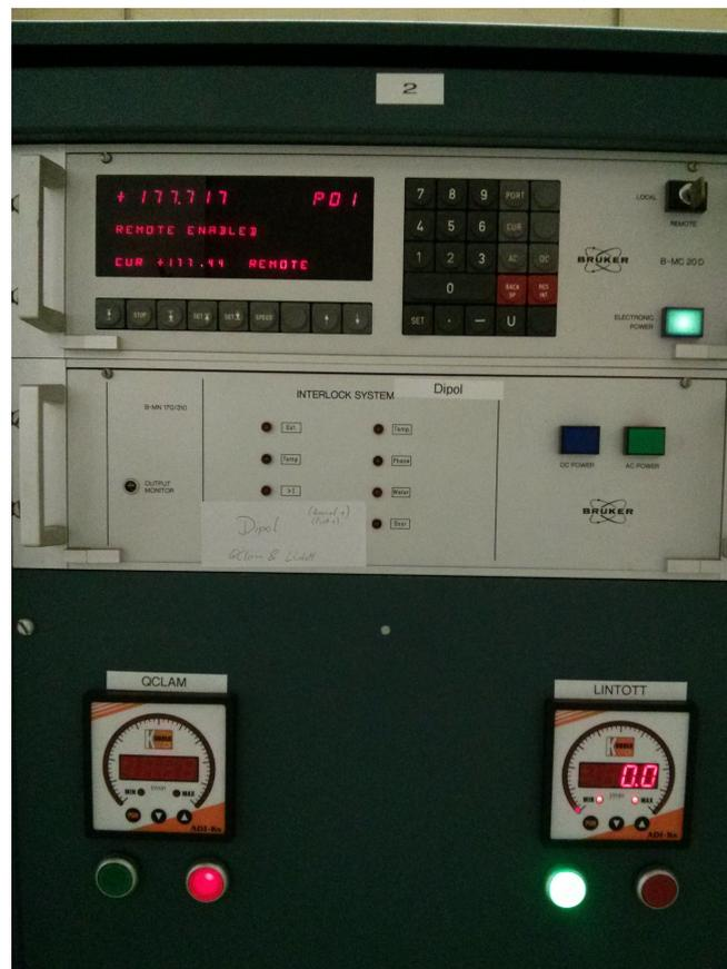
**Abbildung 2.2:** Das Kontrollpanel des Netzteils. Am unteren Rand des Bildes ist die Umschaltung zwischen Lintott und QCLAM zu sehen. Am Kontrollbildschirm ist zu erkennen, dass das Netzteil im remote-Modus betrieben wird und auf Port 1 177,717 Ampere eingestellt sind.
