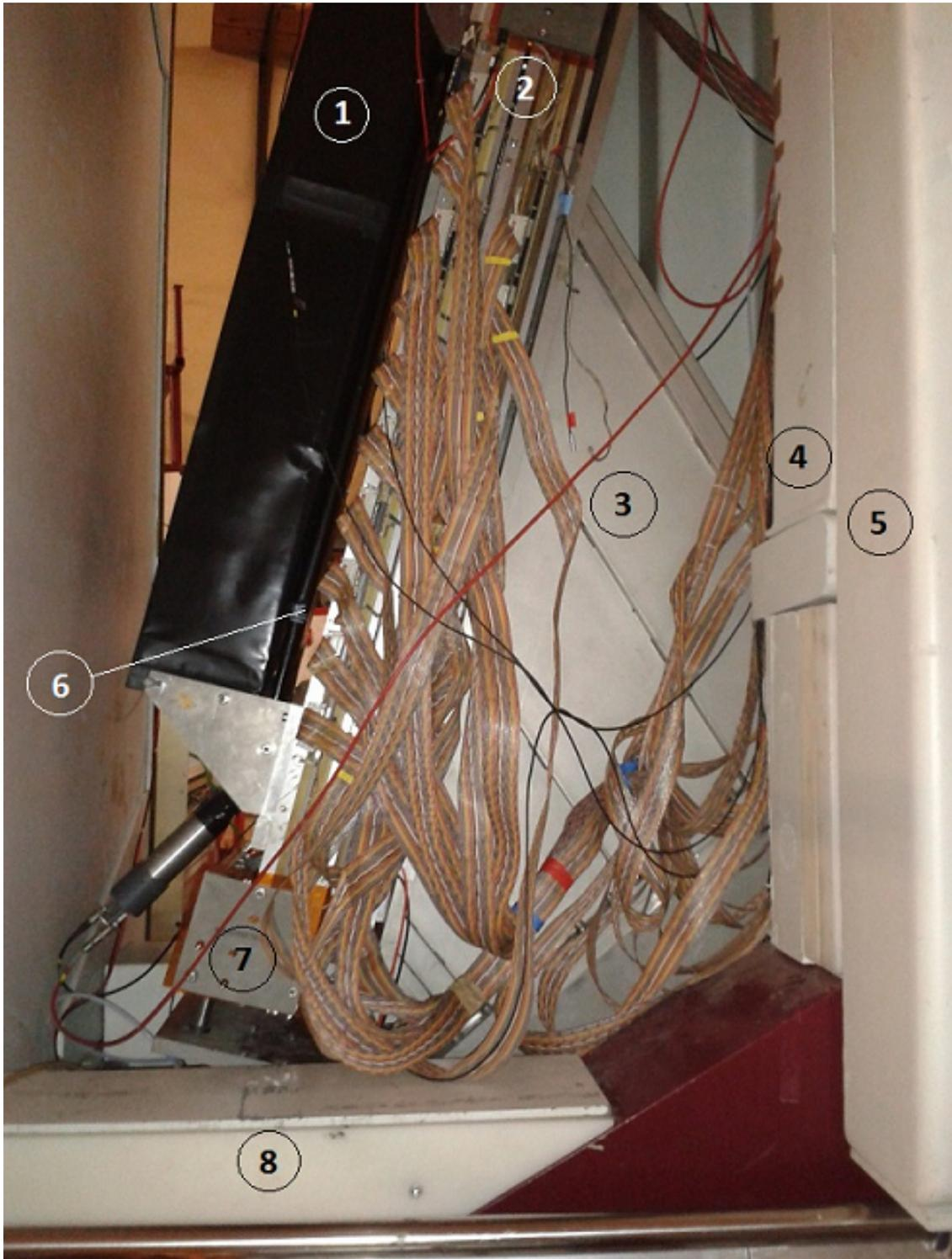
**Abbildung 2.2:** Aufnahme vom QCLAM mit eingebauten Detektorsysteme: (1) Čerenkovdetektor; (2) Angeschlossene Driftkammern; (3) Vakuumkammer; (4) Abschirmungswand; (5) Abschirmungstür; (6) Szintillator; (7) Vorhandene, untere Führungsschienen. Sie sind auf dem Foto durch eine Schutzplatte verdeckt; (8) Abschirmungsblock;
