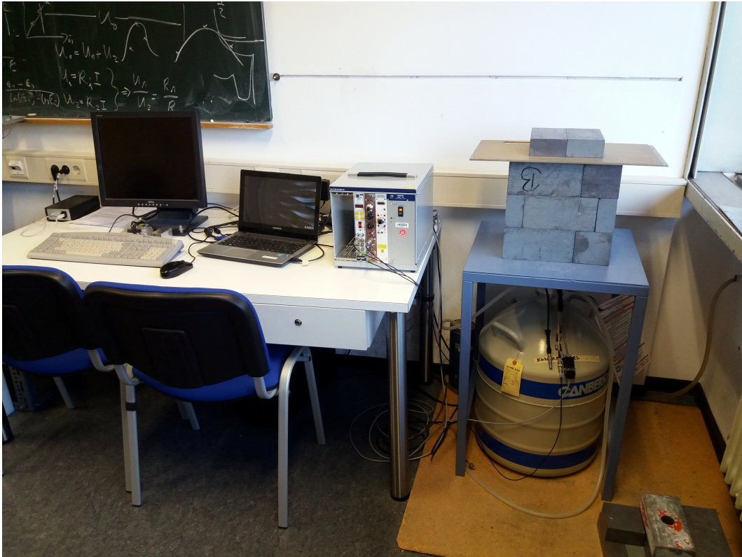
Abbildung 3.2: Gesamtübersicht über den Messplatzes für den Versuch Radioaktivität in der Umwelt . Rechts unter der Bleiburg ist das Dewar-Gefäss für den Germaniumdetektor zu sehen.
