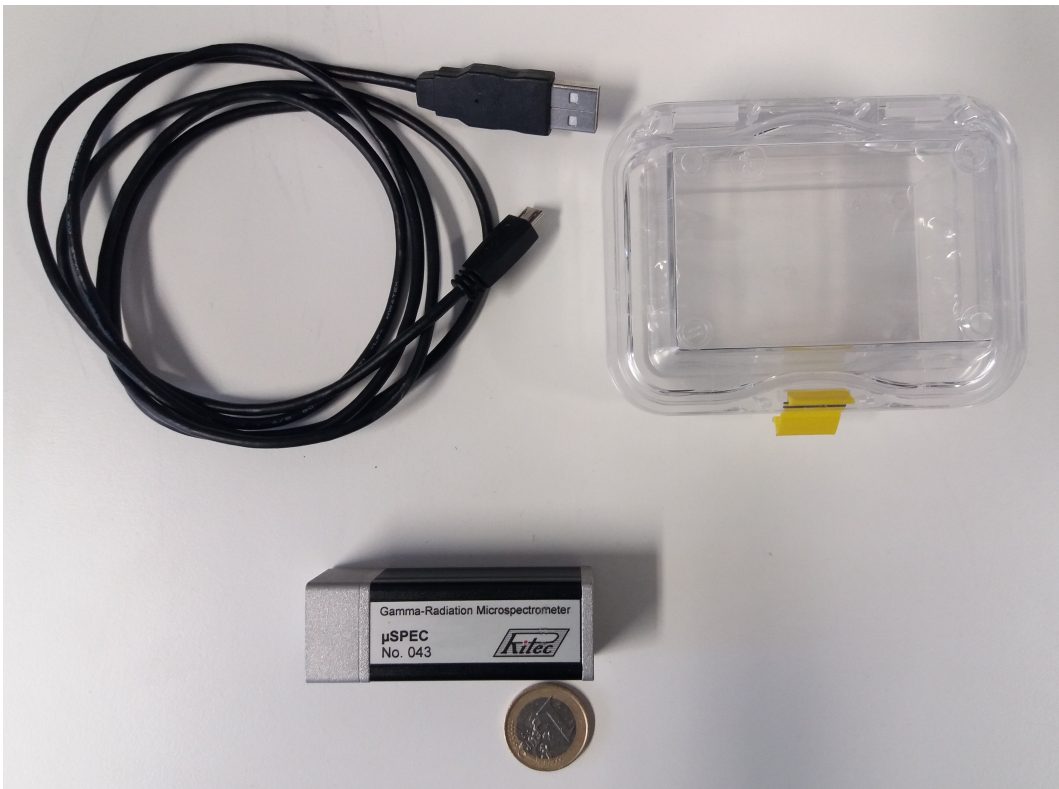
Abbildung 3.3: Cadmium-Zink-Tellur-Detektor (Gamma-Mini-Spektrometer) als Zweitdetektor.
